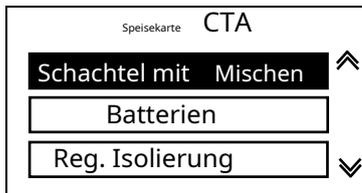
Anwesenheit: Ermöglicht die Angabe des Vorhandenseins einer Mischklappe. Fahrzeit: Öffnungs- oder Schließzeit der Mischklappe. Min.A.neuf: Ermöglicht die Zugabe eines Mindestprozentsatzes an Frischluft
